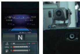
最新の安全装置（衝突防止補助システム【車間距離・ふらつき警報】、ドライバーモニター【居眠り運転防止】）など安全性を高める最新の装置を導入しています。
